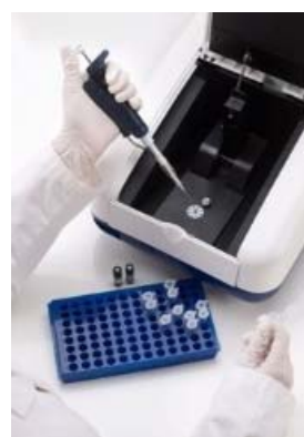
Figura 7.3. Micropipetarea soluției pe capul de citire
