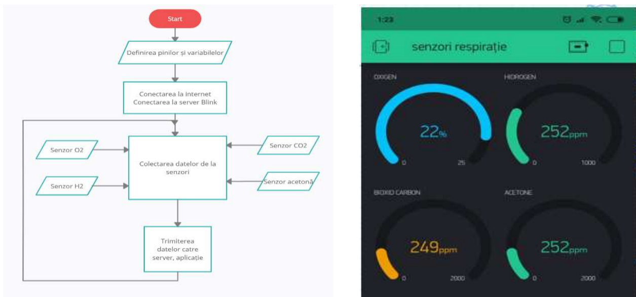
Figura 2. Modul de funcționare a dispozitivului și afișarea datelor.
