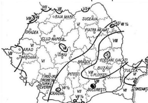
Figura 2. Zonarea seismică a teritoriului României (STAS 11 100/1-1977) [2]
