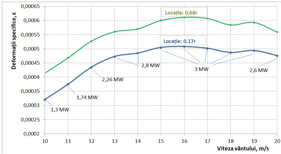
Fig. 4.7. Diagrama rezultatelor simulării palei turbinei.
