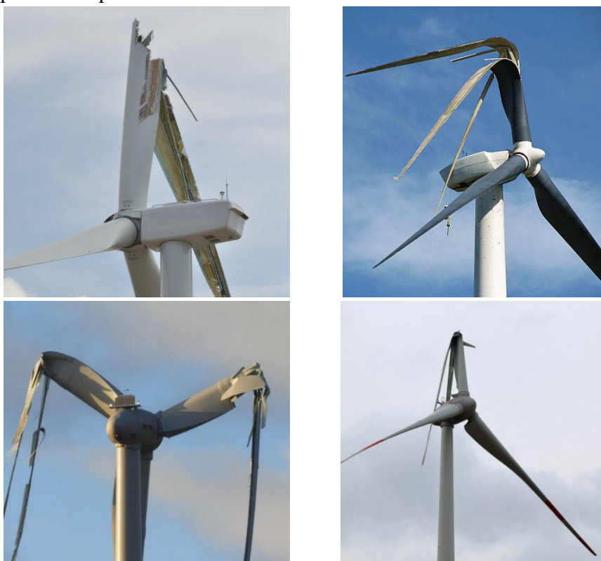
Fig. 3.2. Locația și aspectul deteriorărilor palelor turbinelor eoliene existente.
