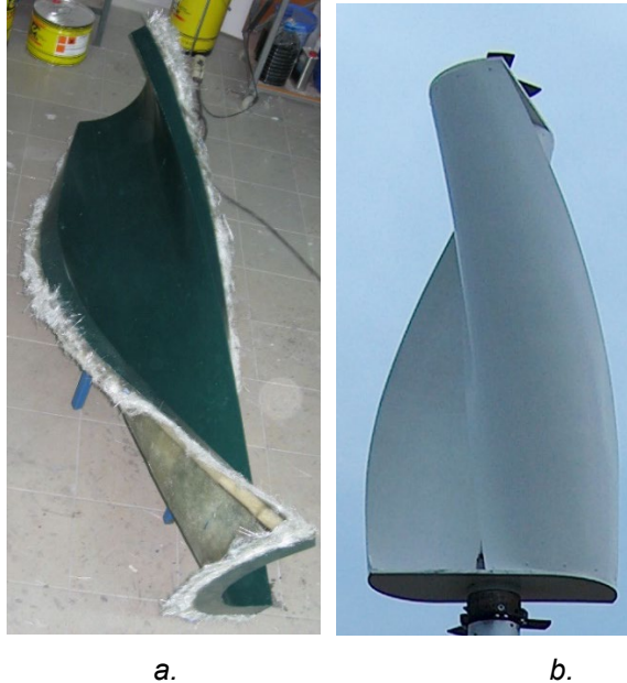
Fig. 2.24. Rotor eolian Savonius: a – pala executată din material compozit; rotor cu 2 pale.
