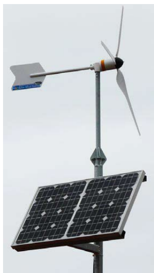
Fig. 3.4. Sisteme hibrid eolian-solar pentru iluminarea spațiilor deschise.
