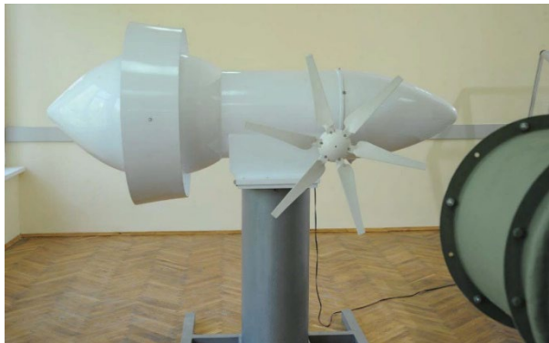
Fig. 2.21. Nodul nacela + roțile vindroză în Laboratorul de Aerohidrodinamică.
