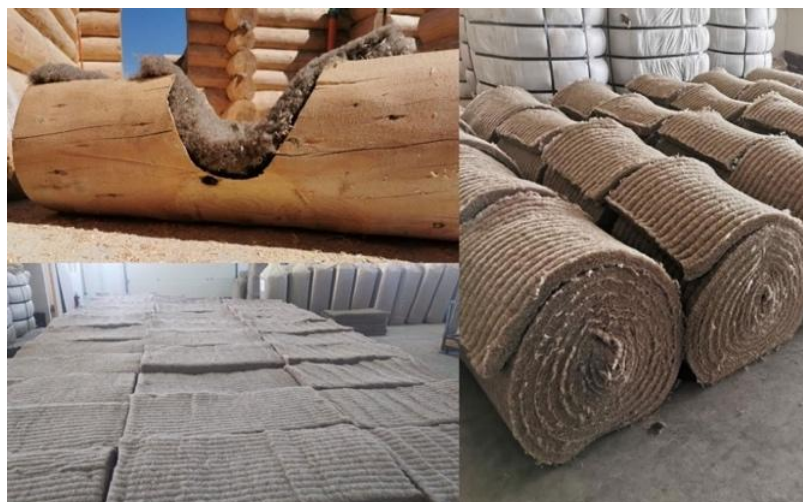
Figura 8. Izolație din lână de oaie [6]
