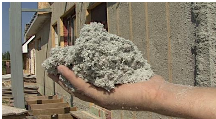
Figura 6. Izolație termică din celuloză [4]
