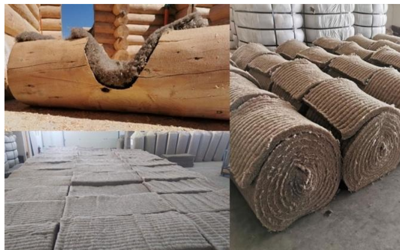
Figura 8. Izolație din lână de oaie [6]
