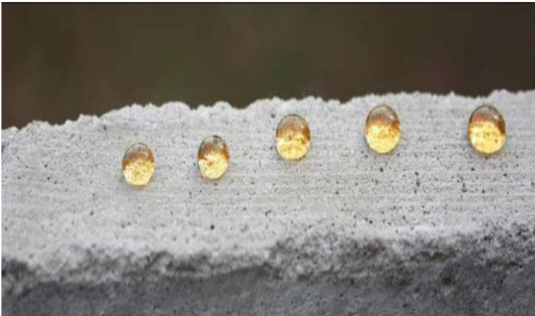
Fig. 7. Hidrofobizarea suprafeței de calcar cu agenți de protecție universali
